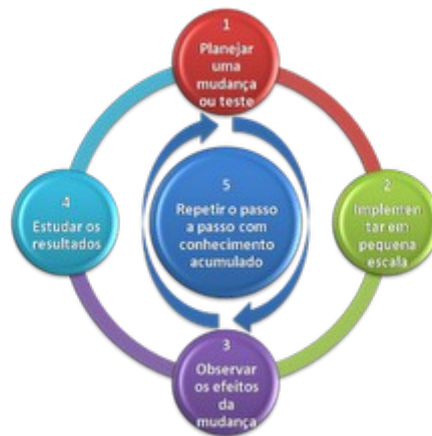
Figura 4: Ciclo de Shewhart para processos repetitivos de melhoria. Fonte - Moen e Norman (2007).
